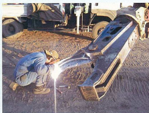
現場出張での溶接修理
